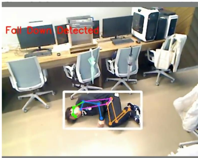
Fig 9. 실시간으로 스트리밍 된 영상을 바탕으로 한 pose estimation 모델의 추론 영상
